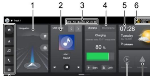
1. Навигация. Нажмите для входа в интерфейс навигации. Более подробную информацию см. в Руководстве по эксплуатации информационно-развлекательной системы.
