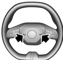
Чтобы включить звуковой сигнал, нажмите на кнопку клаксона (как показано стрелкой) на рулевом колесе.
