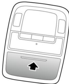
Ящик для очков расположен в непосредственной близости к передним фонарям внутреннего освещения. Нажмите на панель (как показано стрелкой) и поместите очки в ящик для очков после его открытия. Закрывайте ящик для очков, когда он не используется.
