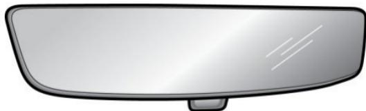
Переместите рычаг на основании внутреннего зеркала заднего вида, чтобы изменить угол его наклона для обеспечения функции защиты от ослепления. Нормальная видимость восстанавливается, если снова потянуть рычаг обратно.
