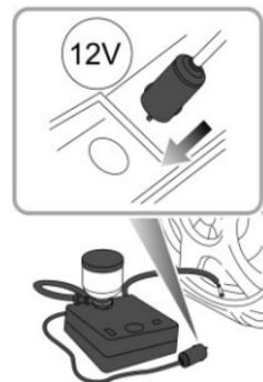
**Примечание.** Чтобы избежать разрядки аккумулятора, рекомендуется держать автомобиль на передаче P в режиме READY (готовность).
