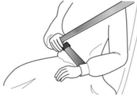
3. Вставьте металлический язычок в пряжку до звука щелчка; это будет означать, что ремень безопасности надежно зафиксирован.
