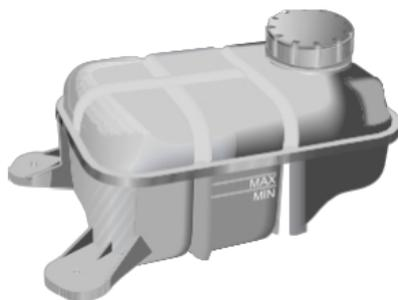
Уровень охлаждающей жидкости следует проверять еженедельно, когда система охлаждения холодная и автомобиль стоит на ровной поверхности.
