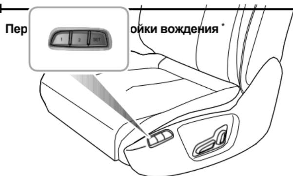
Автомобили с функцией памяти могут предоставить более богатый набор персонализированных настроек вождения: регулировка и запоминание положения сиденья и угла наклона наружного зеркала заднего вида (позволяет устанавливать и сохранять персонализированные настройки двух водителей).
