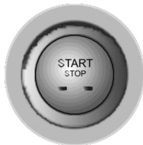
Замок зажигания с функцией бесключевого запуска расположен на правой панели приборов на рулевой колонке и относится к кнопочному запуску. Для работы системы необходимо, чтобы ключ находился в автомобиле.
