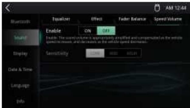
Если включена функция Speed Volume, громкость звука соответствующим образом усиливается и компенсируется по мере увеличения скорости автомобиля, а по мере уменьшения скорости компенсация снижается.
